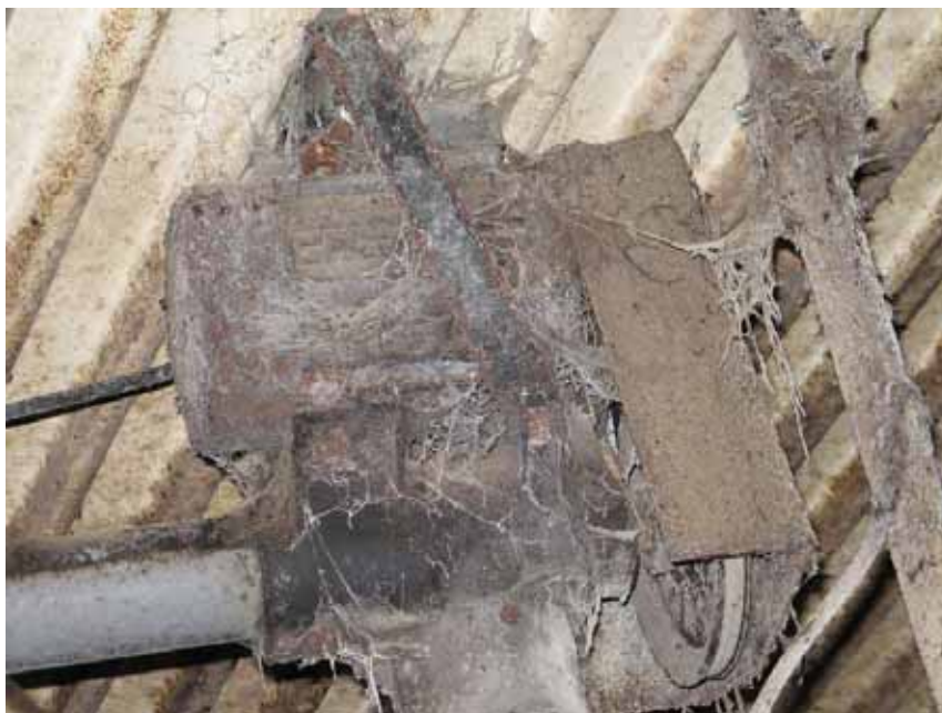
Kuva 6. Harsomaisen pölyn peitossa oleva ruokintalaitteen sähkömoottori.
